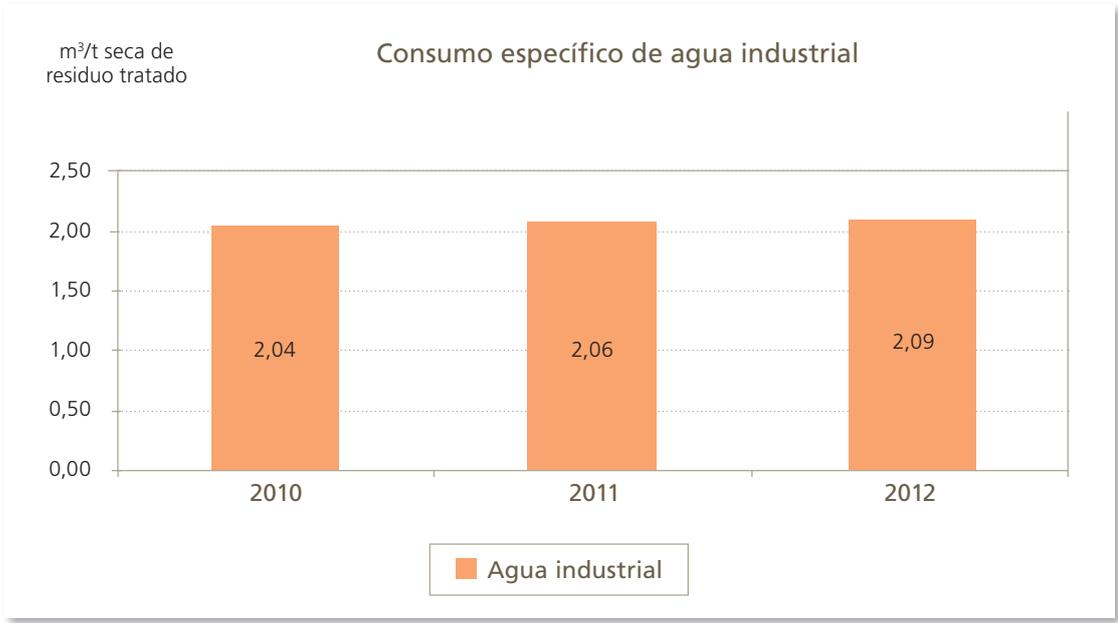
El consumo de agua industrial se utiliza principalmente en el proceso de lixiviación y por tanto, al igual que el bicarbonato sódico, depende del contenido de elementos halógenos y alcalinos en el óxido Waelz alimentado al proceso de lixiviación y éstos a su vez de la composición de estos elementos en los residuos a recuperar.
