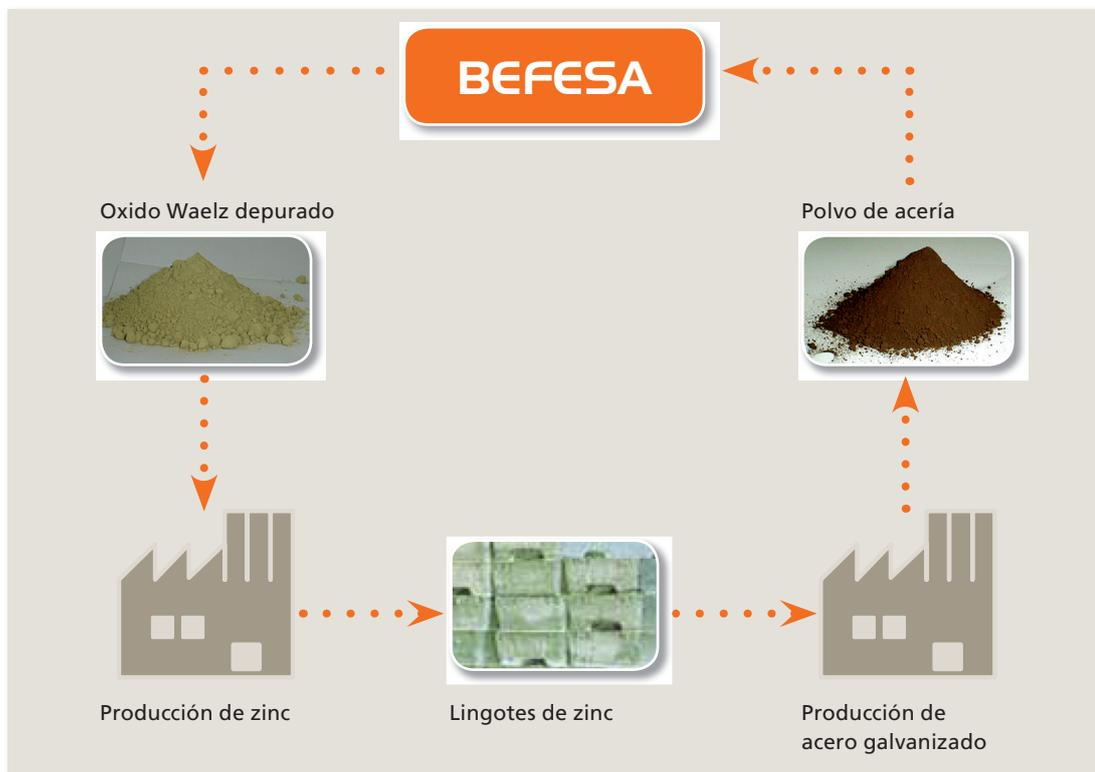
Los polvos residuales de las acerías son alimentados a un horno Waelz donde se producen las reacciones necesarias de reducción/oxidación para separar del resto de los elementos de los polvos de acería los metales pesados, fundamentalmente el Zn y Pb, que son reoxidados formando el Óxido Waelz.
