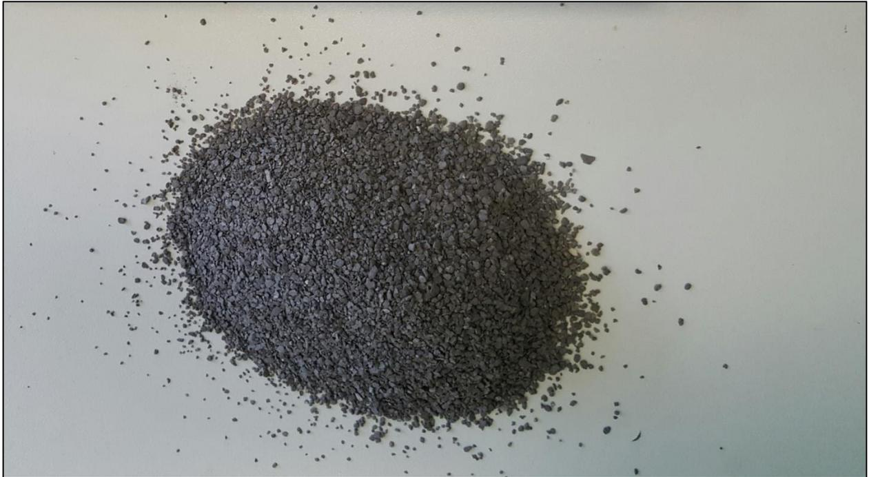
**Abbildung 2:** Aluminium-Granulat
