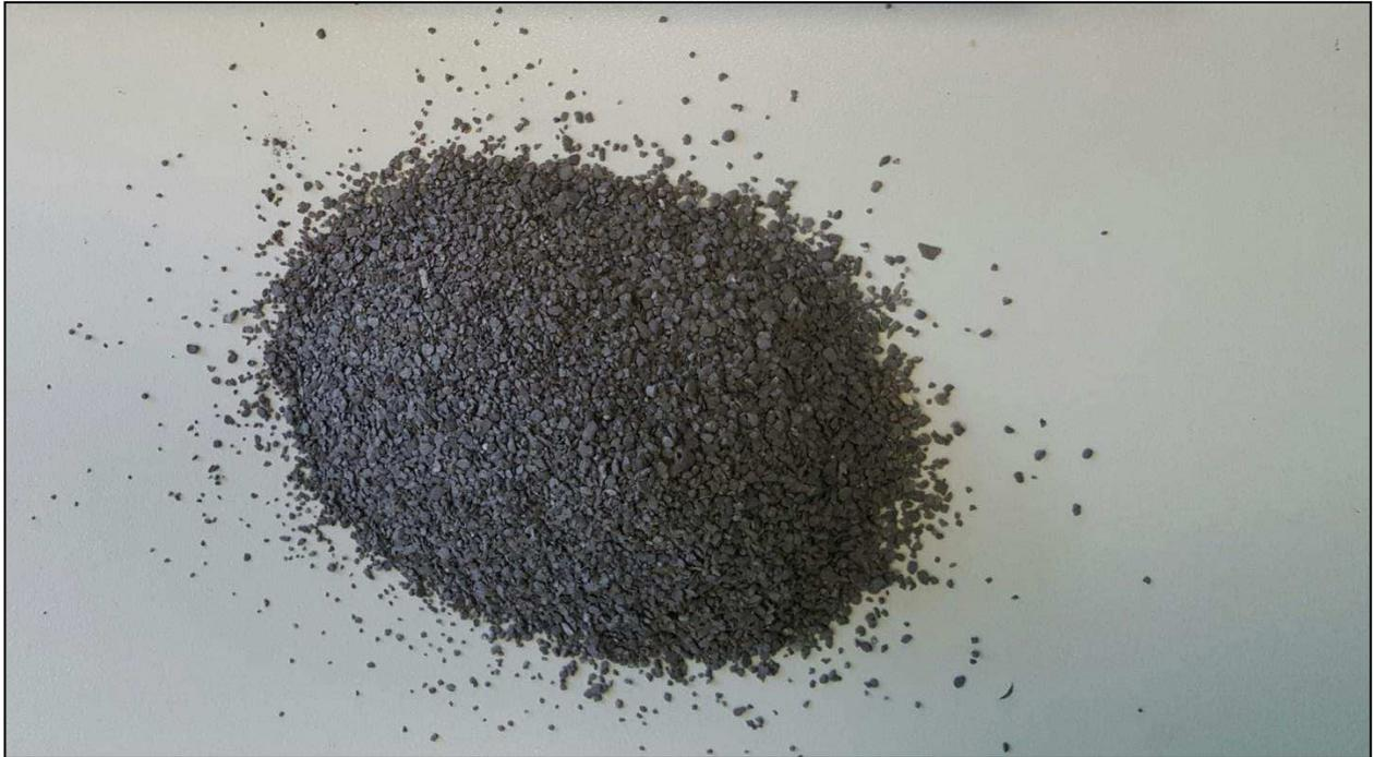
**Abbildung 2:** Aluminium-Granulat
