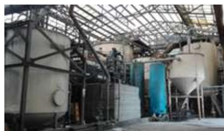
La mezcla es bombeada a reactores donde reaccionan los compuestos aluminosos, mediante el mantenimiento de la temperatura. Los gases producidos en los reactores son incinerados en la antorcha.
